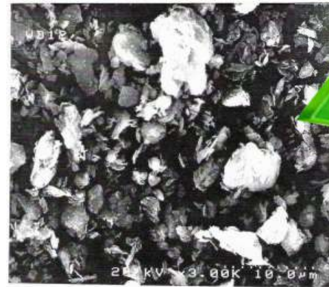
对照多孔性陶瓷原料的细微气孔 电子显微镜图片×5000倍
