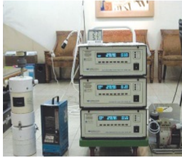
실내오염물질의 측정 (CO, NO2, 오존, 석면)
